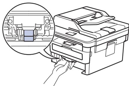
6. Rechargez le papier et réinstallez le bac à papier à fond dans l'appareil.
