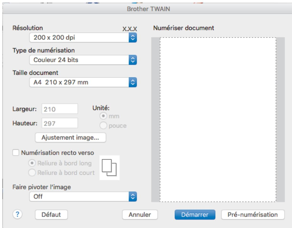
2. Au besoin, modifiez les paramètres de numérisation, tels que **Résolution**, **Type de numérisation** ou **Ajustement image**.
