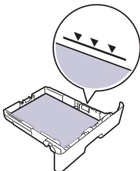
5. Réinstallez le bac à papier à fond dans l'appareil.
