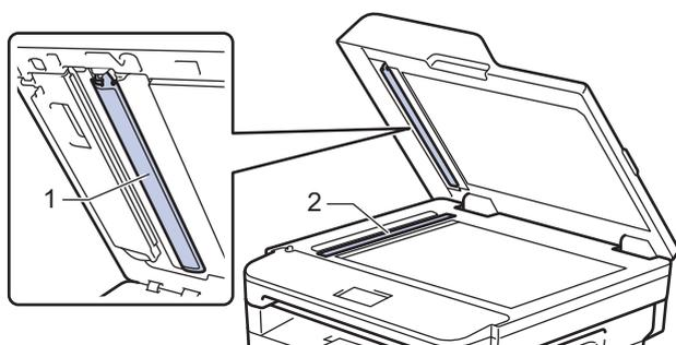
4. Ouvrez le capot en verre du scanner (1), nettoyez l'autre barre blanche (2) et la bande de verre du scanner (3) (modèles pris en charge uniquement).
