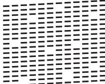
6 液晶显示屏将要求您检查各色块的打印质量。按 ◀ 或 ▶ 选择与打印效果最为匹配的图样 (1 ~ 4)，然后按 OK。
