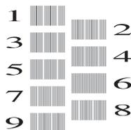
**5** Per lo schema (A), premere **◀** o **▶** per selezionare il numero della prova di stampa con le linee verticali meno visibili (1-9), quindi premere **OK**.
