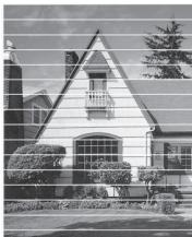
Una vez que el inyector del cabezal de impresión esté limpio, desaparecerán las líneas.
