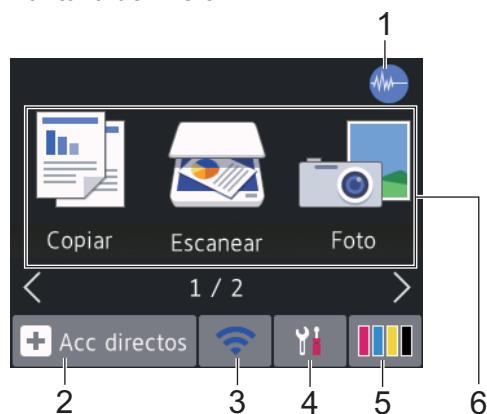
En esta pantalla se muestra el estado del equipo cuando está inactivo. Cuando se muestra, indica que el equipo está listo para ejecutar el comando siguiente.
