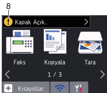
Uyarı simgesi bir hata veya bakım mesajı olduğunda görünür; ayrıntıları görüntülemek için öğesine basın ve sonra Ana ekrana dönmek için öğesine basın.
