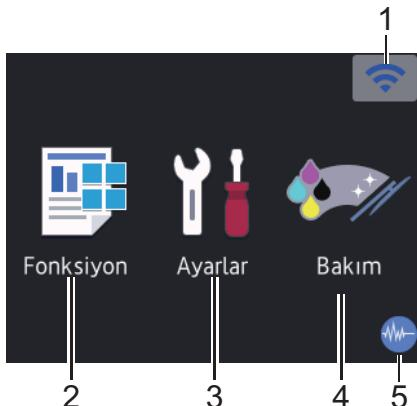
Bu ekran, makine boştayken, makinenin durumunu gösterir. Görüntülendiğinde, makinenizin bir sonraki komut için hazır olduğu anlamına gelir.
