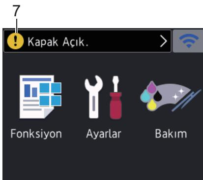
Uyarı simgesi bir hata veya bakım mesajı olduğunda görünür; ayrıntıları görüntülemek için öğesine basın ve sonra Ana ekrana dönmek için öğesine basın.
