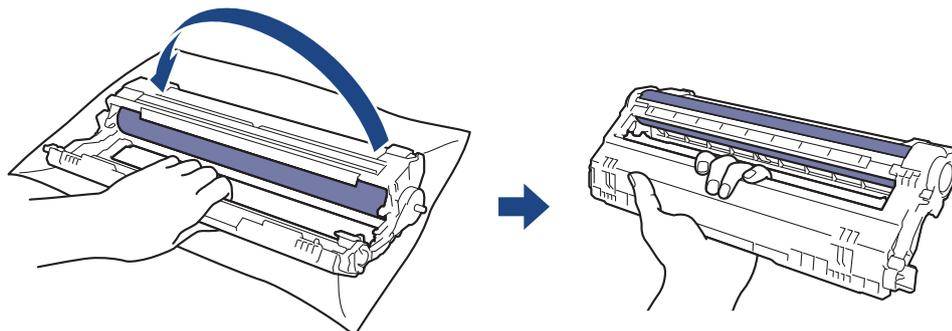
10. Afrouxe a pressão de modo que a estrutura caia para a frente e, em seguida, use a mão direita para encaixar a engrenagem da unidade de cilindro dentro do lado direito da estrutura.
