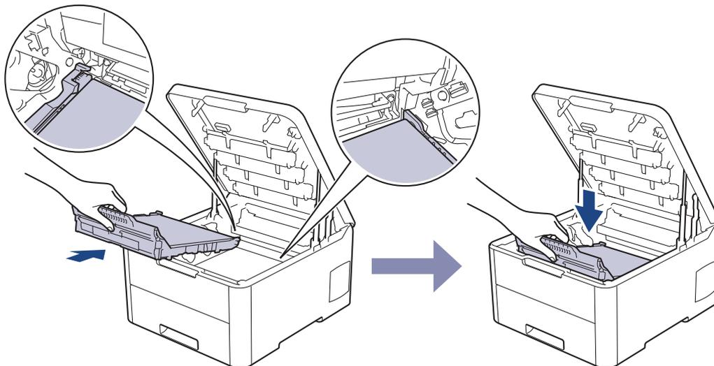
9. Reinstale no equipamento cada conjunto de unidade de cilindro e cartucho de toner. Certifique-se de fazer com que a cor do cartucho de toner corresponda à cor na etiqueta do equipamento para todos os quatro conjuntos de cartucho de toner e unidade de cilindro.
