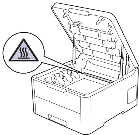
6. A cor dos pontos impressos na Folha de Verificação de Pontos do Cilindro é da cor do cilindro que você deve limpar. Remova o conjunto de cartucho de toner e unidade de cilindro referente à cor que está causando o problema.
