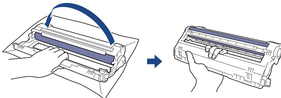
9. Afrouxe a pressão de modo que a estrutura caia para a frente e, em seguida, use a mão direita para encaixar a engrenagem da unidade de cilindro dentro do lado direito da estrutura.
