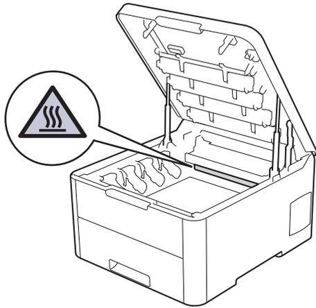
7. A cor dos pontos impressos na Folha de Verificação de Pontos do Cilindro é da cor do cilindro que você deve limpar. Remova o conjunto de cartucho de toner e unidade de cilindro referente à cor que está causando o problema.
