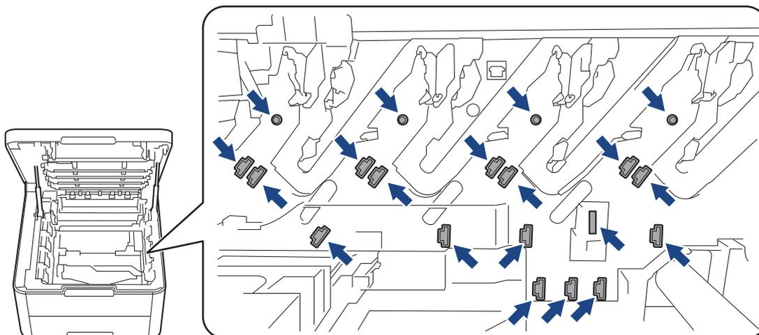
3. Limpe o fio corona dentro da unidade de cilindro, deslizando gentilmente a aba verde da esquerda para a direita e da direita para a esquerda por várias vezes. Repita esta etapa para todos os fios corona.
