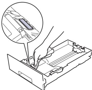
5. Limpe os dois rolos de tração dentro do equipamento para remover a poeira.
