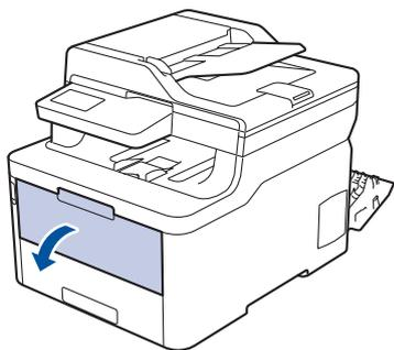
3. 用雙手將手動進紙槽的紙張調整器滑動到所用紙張的寬度。
