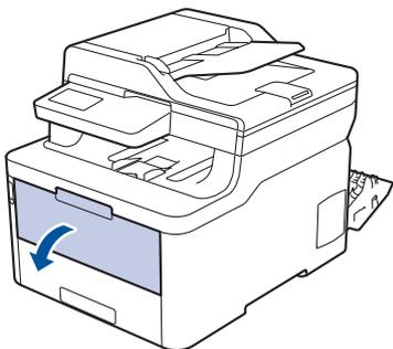
4. 用雙手將手動進紙槽的紙張調整器滑動到所用紙張的寬度。
