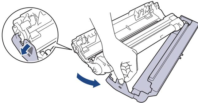
7. 將碳粉匣穩固地重新插入新感光鼓元件，直到聽見卡入定位。
