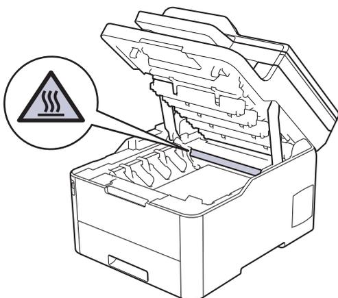
3. 取出液晶幕上所顯示顏色的碳粉匣和感光鼓元件組件。
