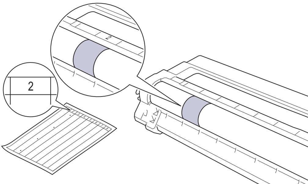
11. 用乾的棉花棒輕輕擦拭感光鼓表面，直到去除表面的污點為止。
