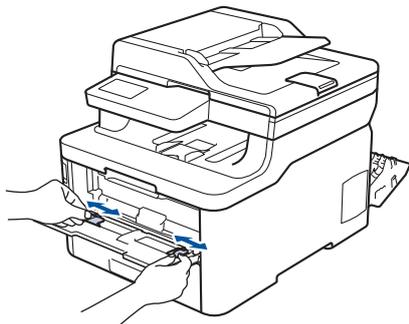
5. 用雙手將一個信封放入手動進紙口，直到前端碰觸到進紙滾軸。感覺到機器拉入信封時，即可放開。
