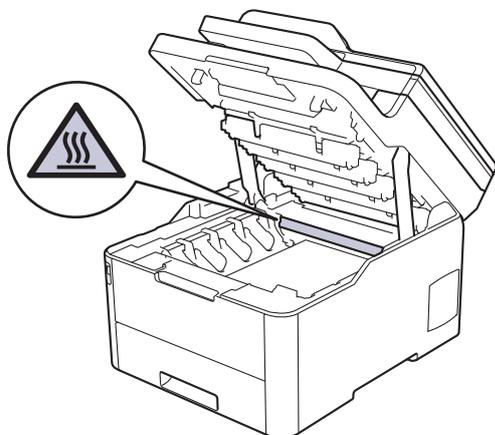
6. 感光鼓檢查列印頁上印出圓點的颜色就是您應清潔的感光鼓的颜色。取出引起问题的颜色的碳粉匣和感光鼓元件组件。
