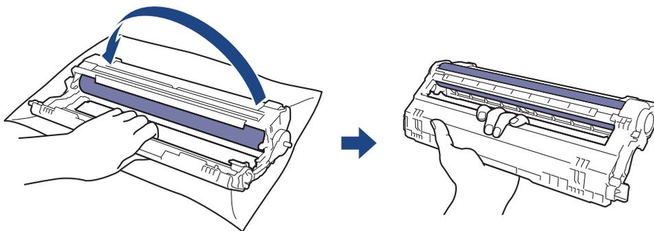
9. 鬆開把手，使外框朝前落下，然後用右手將感光鼓元件齒輪定位在外框右側內。
