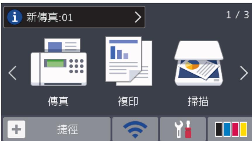
[傳真預覽] 設為 [開] 時，記憶體中已接收的新傳真的數量顯示在螢幕頂部。
