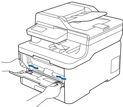
4. 用雙手將一張紙放入手動進紙口，直到紙張前端碰觸到進紙滾軸。感覺到機器拉入信封時，即可放開。
