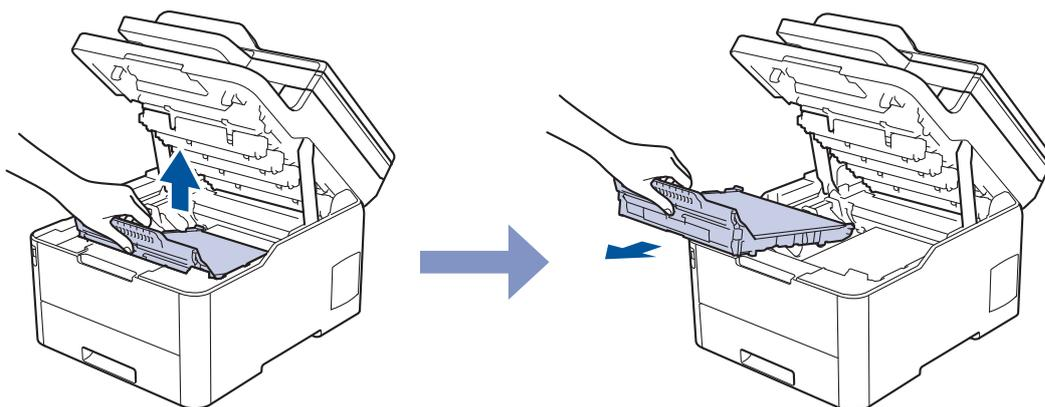
5. 拆開新皮帶組的包裝，再將新皮帶組插入機器內。
