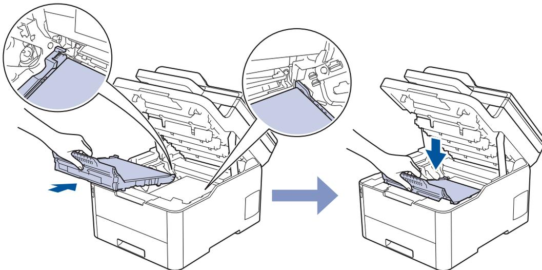
9. 將各碳粉匣和感光鼓元件組重新插入機器。確定所有四個碳粉匣和感光鼓元件組的顏色與機器上的顏色標籤相符。
