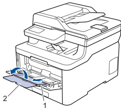
4. 滑動多功能進紙匣的紙張調整器，以符合所用紙張的寬度。
