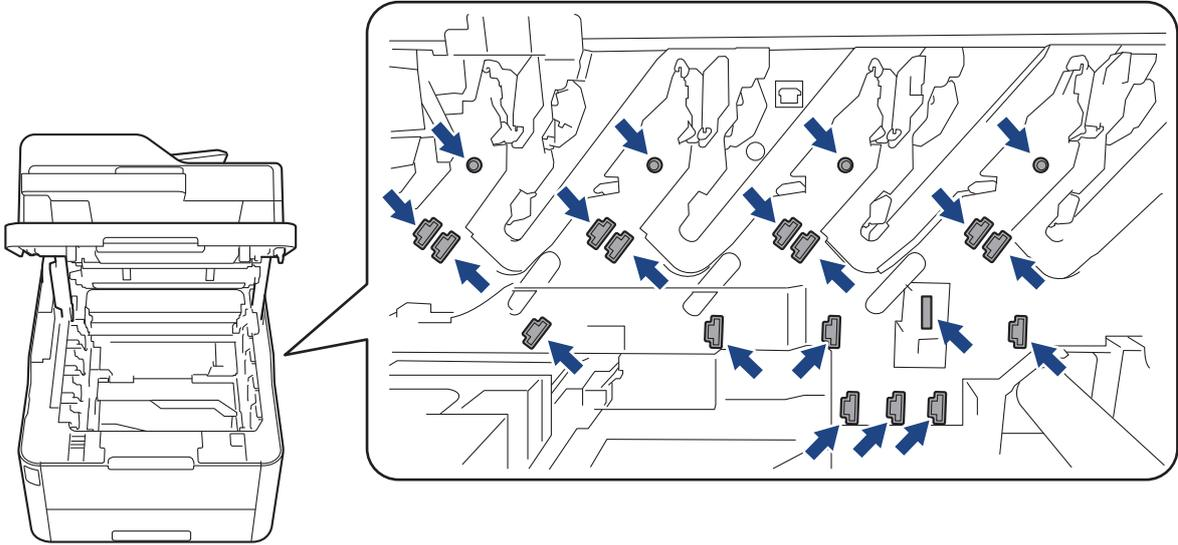
3. 左右輕輕推動綠色滑塊數次，以清潔感光鼓元件內的電極絲。對所有電極絲重複執行此步驟。
