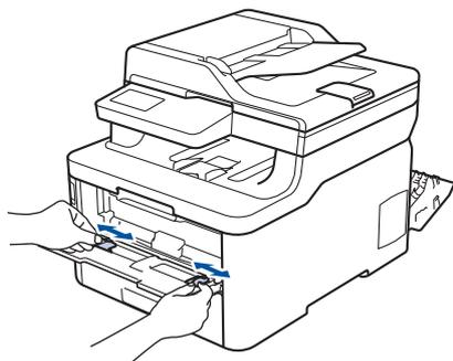
4. 用雙手將一張紙放入手動進紙口，直到紙張前端碰觸到進紙滾軸。感覺到機器拉入信封時，即可放開。
