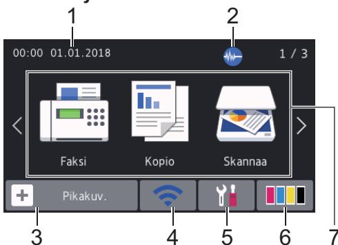
Tästä näytöstä näet laitteen tilan laitteen ollessa valmiustilassa. Kun tämä näkyvä näytöllä, se tarkoittaa, että laite on valmis vastaanottamaan komentoja.
