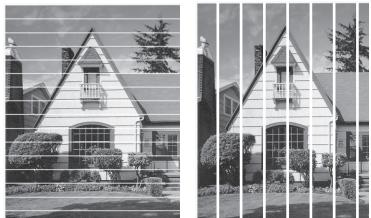
После прочистки этого сопла линии исчезнут.
