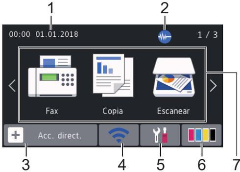
En esta pantalla se muestra el estado del equipo cuando está inactivo. Cuando se muestra, indica que el equipo está listo para ejecutar el comando siguiente.
