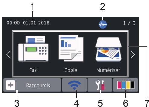
Cet écran affiche l'état de l'appareil lorsque ce dernier est inactif. Lorsqu'il est affiché, cet écran indique que l'appareil est prêt pour la commande suivante.
