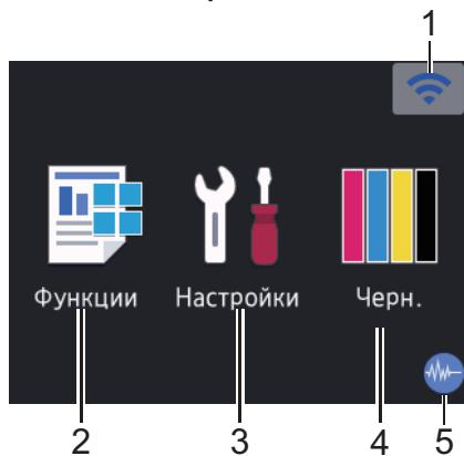
На этом экране отображается состояние устройства в режиме простоя. Отображение этого экрана означает, что устройство готово к получению следующей команды.
