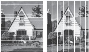
После прочистки этого сопла линии исчезнут.
