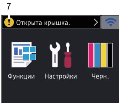
Предупреждающий значок **!** отображается при наличии ошибки или сообщения по обслуживанию. Нажмите кнопку **!** для просмотра дополнительных сведений, а затем нажмите **X** для возврата на начальный экран.
