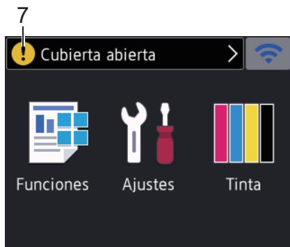
El ícono de advertencia aparece cuando hay un mensaje de error o de mantenimiento; pulse para ver los detalles y, a continuación, pulse para volver a la pantalla de inicio.
