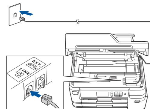
Свържете телефонния кабел. Използвайте гнездото, маркирано с LINE, и прекарате кабела през задната част на устройството.
