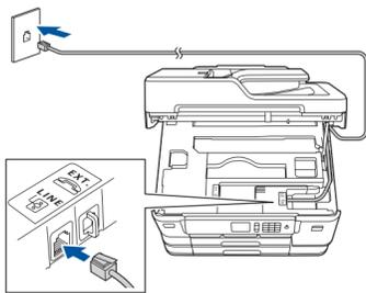
Подключите телефонный провод. Подключите провод к гнезду с маркировкой **LINE** и выведите провод наружу через заднюю стенку устройства.
