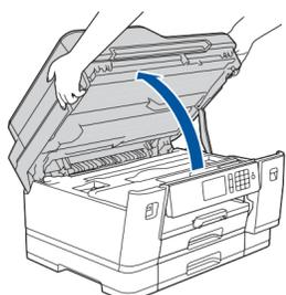
Поднимите крышку сканера.
