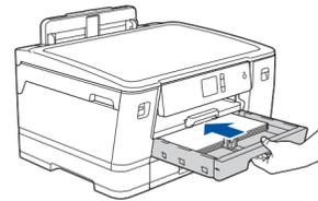
Schieben Sie die Papierkassette langsam vollständig in das Gerät.
