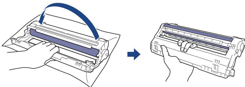
9. Otpustite stisak ruke kako bi okvir pao prema naprijed te potom desnom rukom nađite zupčanik jedinice bubenja u unutrašnjosti desne strane okvira.
