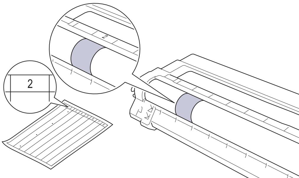
11. Pažljivo brišite površinu bubenja suhim pamučnim štapićem dok ne skinete trag na površini.
