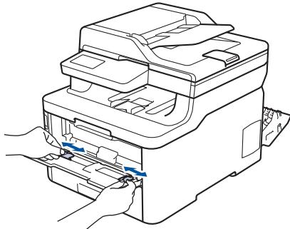
5. Objema rukama stavite jednu kuvertu u otvor za ručno ulaganje tako da prednji rub dodiruje valjak za ulaganje papira. Kada osjetite da je uređaj povukao kuvertu, pustite je.
