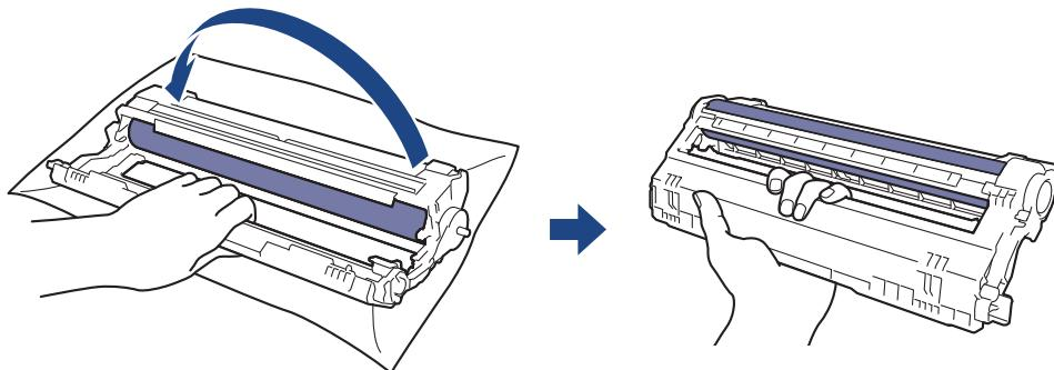
9. Otpustite stisak ruke kako bi okvir pao prema naprijed te potom desnom rukom nađite zupčanik jedinice bubnja u unutrašnjosti desne strane okvira.
