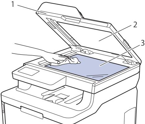
3. U jedinici AUD-a očistite bijelu traku (1) i staklenu prugu skenera (2), koja se nalazi ispod nje, vlažnom mekanom krpom koja ne ostavlja dlačice.
