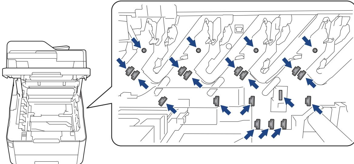
3. Očistite koronsku žicu unutar jedinice bubnja laganim klizanjem zelene pločice zdesna nalijevo i obrnuto nekoliko puta. Ponovite ovaj postupak za sve koronske žice.
