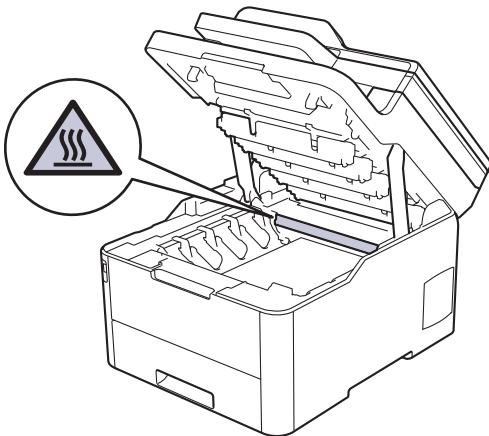
3. Uklonite sklop tonera i jedinice bubnja za boju naznačenu na LCD zaslonu.
