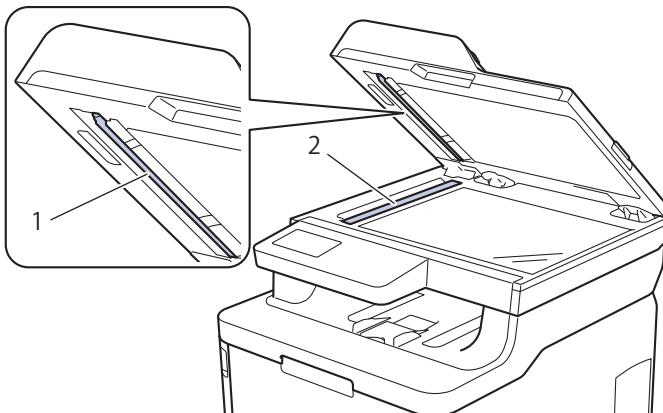
4. Otvorite poklopac stakla skenera (1) i zatim očistite drugu bijelu traku (2) i prugu stakla skenera (3) (samo za podržane modele).
