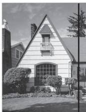
Wenn der Glasstreifen verschmutzt ist, tritt im Scan eine vertikale Linie auf.
