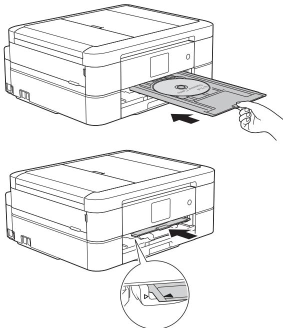
6. 印刷が終わったら、ディスクトレイを引いて取り出し、印刷された記録ディスクを取り外します。
