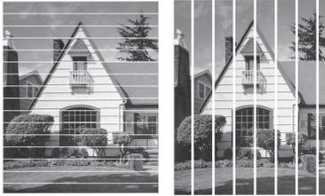
プリントヘッドのノズルをクリーニングすると、筋は解消されます。
