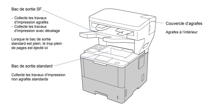
Grâce à l'agrafeuse (SF), votre appareil Brother dispose de nouvelles fonctions de sortie papier, comme l'agrafage, le décalage et l'empilement. Vous pouvez sélectionner ces fonctions dans le pilote de l'imprimante, sur l'écran LCD de votre appareil Brother ou via la Gestion à partir du Web.
