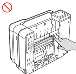
切勿握住掃描器頂蓋 (限某些型號)、卡紙清除蓋、手動進紙口蓋 (限某些型號) 或控制面板來搬動本產品，否則產品可能會從手中滑落，導致受傷。
