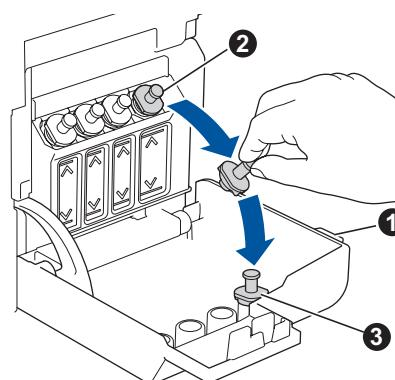
Otvorite poklopac rezervoara za mastilo 1, skinite čep 2 i stavite ga na unutrašnju stranu poklopca 3.
