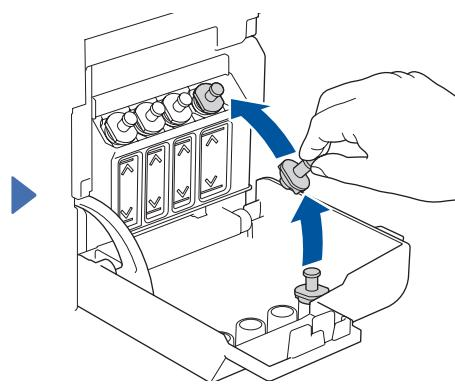
Vratite čep na rezervoar za mastilo. Ponovite korak 5 za ostale rezervoare za mastilo, a zatim zatvorite poklopac rezervoara za mastilo.
