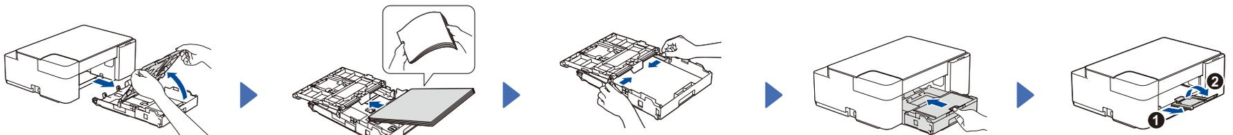
Sortez complètement le bac à papier de l'appareil, puis ouvrez le couvercle du bac de sortie.
