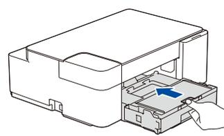
Poussez fermement le bac à papier dans l'appareil pour le remettre en place.
