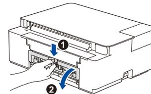
Ouvrez le couvercle d'élimination des bourrages à l'arrière de l'appareil.
