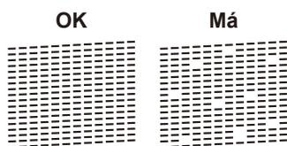
Siga as instruções do LCD para verificar a qualidade dos quatro blocos coloridos que aparecem na folha e, em seguida, inicie o procedimento de limpeza.
