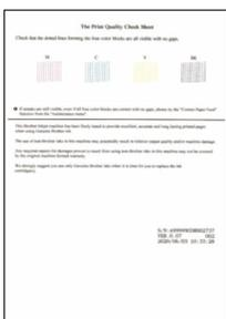
Folgen Sie den Anweisungen auf dem Display und drücken Sie dann [OK] oder ►. Die Testseite zur Überprüfung der Druckqualität wird gedruckt.
