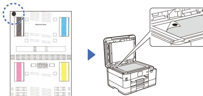
Folgen Sie den Anweisungen auf dem Display, um die Seite für die Druckanpassung zu drucken. Die schwarze Kreismarkierung befindet sich oben links auf der Seite.
