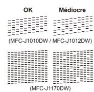
Suivez les instructions affichées à l'écran ACL pour vérifier la qualité des quatre blocs de couleur sur la feuille, puis lancez la procédure de nettoyage, si nécessaire.
