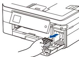
Abra la cubierta de los cartuchos de tinta y retire la pieza de protección de color naranja del equipo.
