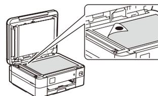
Coloque la hoja de ajuste boca abajo sobre el cristal del escáner. Asegúrese de que la marca con un círculo negro se encuentre en la esquina superior izquierda del cristal del escáner.
