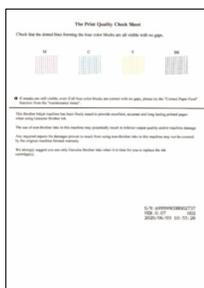
Siga las instrucciones que aparecen en la pantalla LCD y, a continuación, pulse [OK] o ▶. El equipo imprimirá la hoja de revisión de calidad de impresión.
