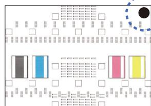
Ikuti petunjuk di LCD untuk mencetak Adjustment Sheet. Tanda lingkaran hitam terletak di sudut kanan atas lembar.
