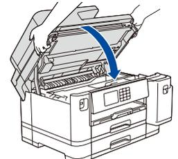
Baje la cubierta del escáner.
