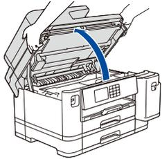
Levante la cubierta del escáner.
