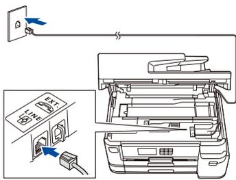
Conecte el cable de línea telefónica. Utilice la toma denominada **LINE** y dirija el cable por la parte trasera del equipo.
