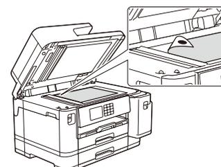
Coloque la hoja de ajuste cara abajo en el cristal de escaneado. Asegúrese de que el círculo negro quede en la esquina superior izquierda del cristal del escáner.
