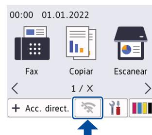
Seleccione el SSID (nombre de la red) para el enrutador/punto de acceso inalámbrico e introduzca la clave de red (contraseña). Cuando se establezca la configuración inalámbrica correctamente, aparecerá [Conectada] en la pantalla LCD.
