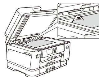
Coloque a folha de ajuste com a face para baixo no vidro do scanner. Certifique-se de que o círculo preto esteja no canto superior esquerdo do vidro do scanner.
