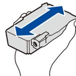
Agite rápida e horizontalmente apenas o cartucho de tinta **preto**, por 15 vezes conforme ilustrado, antes de inseri-lo no equipamento.
