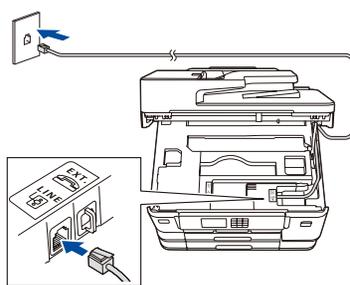
Conecte o cabo de linha telefônica. Use o conector marcado como **LINE** e direcione o cabo por trás do equipamento.
