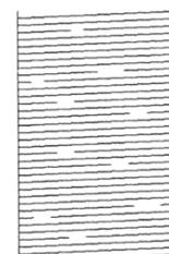
Suivez les instructions affichées à l'écran LCD et vérifiez la qualité des quatre blocs de couleur de la feuille, puis lancez la procédure de nettoyage si nécessaire.
