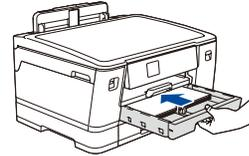
Poussez lentement le bac à papier jusqu'au fond dans l'appareil.
