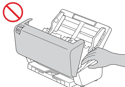
Durante o transporte, NÃO segure o equipamento pelo alimentador automático de documentos (ADF). Isso poderá desacoplar o alimentador automático de documentos (ADF) do equipamento. Durante o transporte, coloque suas mãos sob o gabinete do equipamento.
