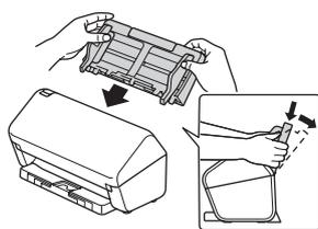
Instale o alimentador automático de documentos (ADF), pressionando-o com firmeza até encaixar no devido lugar.
