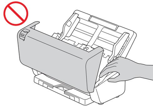
Das Gerät darf NICHT durch Halten am automatischen Vorlageneinzug (ADF) transportiert werden. Bei Nichtbeachtung kann sich der automatische Vorlageneinzug (ADF) vom Gerät lösen. Fassen Sie zum Tragen stets mit beiden Händen unter das Gerät.
