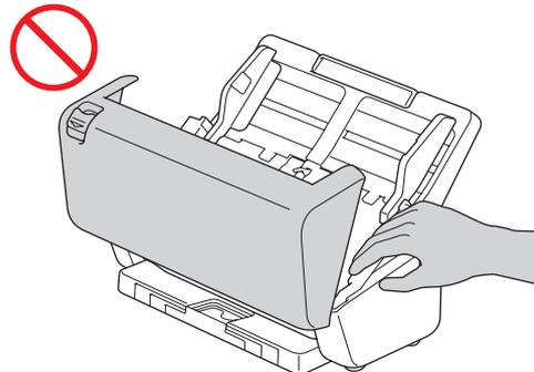
NON trasportare la macchina tenendola per l'alimentatore automatico di documenti (ADF). In caso contrario, si rischia di staccare l'alimentatore automatico documenti (ADF) dalla macchina. Trasportare la macchina solo posizionando le mani sotto tutta la macchina.
