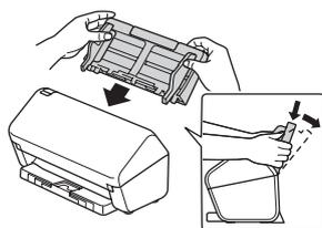
Fissare saldamente l'alimentatore automatico di documenti (ADF) fino a quando si blocca in posizione.
