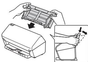
Conecte el alimentador automático de documentos (unidad ADF) con firmeza hasta que se fije.
