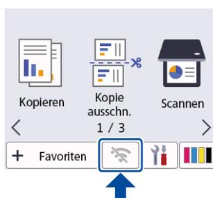
Wählen Sie die SSID (Netzwerkname) für Ihren Access Point/Router aus und geben Sie den Netzwerkschlüssel (Kennwort) ein. Wenn das Wireless-Setup erfolgreich war, wird auf dem Display [Verbunden] angezeigt.
