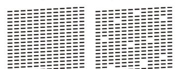
Folgen Sie den Anweisungen auf dem Display und drücken Sie dann [OK]. Das Gerät druckt eine Testseite zur Überprüfung der Druckqualität aus.
