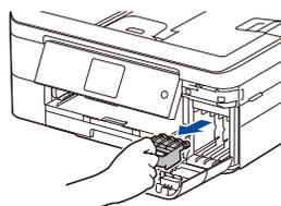
Ouvrez le couvercle des cartouches d'encre et retirez la pièce de protection orange de l'appareil.
