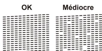
Suivez les instructions affichées à l'écran ACL pour vérifier la qualité des quatre blocs de couleur sur la feuille, puis lancez la procédure de nettoyage, si nécessaire.
