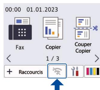
Sélectionnez le SSID (nom du réseau) de votre point d'accès/routeur et entrez la clé de réseau (mot de passe). Une fois la configuration de la connexion sans fil réussie, l'écran ACL affiche [Connecté].
