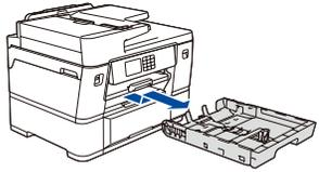
Extraiga completamente la bandeja 1 del equipo, como indica la flecha.
