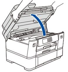
Levante la cubierta del escáner.
