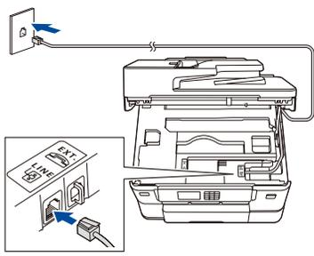
Conecte el cable de línea telefónica. Utilice la toma denominada **LINE** y dirija el cable por la parte trasera del equipo.
