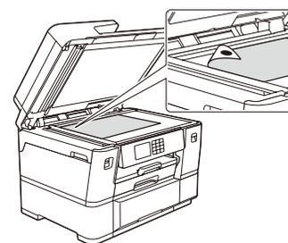
Coloque la hoja de ajuste cara abajo en el cristal de escaneado. Asegúrese de que el círculo negro quede en la esquina superior izquierda del cristal del escáner.
