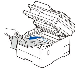
Entfernen Sie die orangefarbenen Teile von jeder Kassette.
