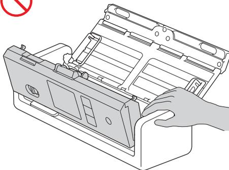
NE transportez PAS l'appareil en tenant le chargeur automatique de documents. Le chargeur automatique de documents risquerait de se détacher de l'appareil. Pour le transporter, placez vos deux mains sous l'appareil.
