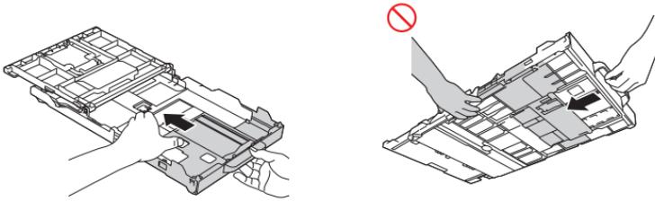
لا تضع أصابعك في المناطق المبينة في الرسم التوضيحي إلا عند إزالة الورق المحشور أو عند تنظيف الجهاز. كن حريصًا عند القيام بذلك، لتجنب الإصابة.
