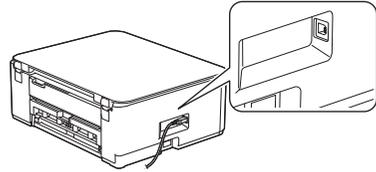
對於 USB 連接，連接到機器側面的正確連接埠，如圖所示。
