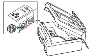
對於有線網路連接和 USB 連接，連接到機器內部的正確連接埠 (視乎您正在使用的傳輸線而定)，如圖所示。
