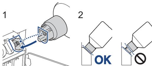
對齊墨瓶，以確保墨槽上的引針可以插入墨瓶的孔中，如 (1) 所示。
