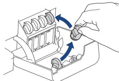
Entfernen Sie den Deckel von der Innenseite der Tankabdeckung und verschließen Sie den Tintentank.
