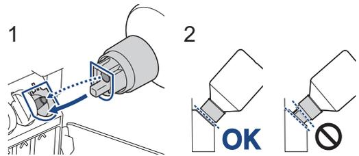
Richten Sie die Flasche so aus, dass der Stift am Tintentank in das Loch in der Flasche eingeführt werden kann, wie in (1) gezeigt.
