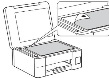
Legen Sie die Seite für die Druckanpassung mit der Vorderseite nach unten auf das Vorlagenglas und achten Sie darauf, dass sich der schwarze Kreis in der oberen linken Ecke des Vorlagenglases befindet (siehe Abbildung).
