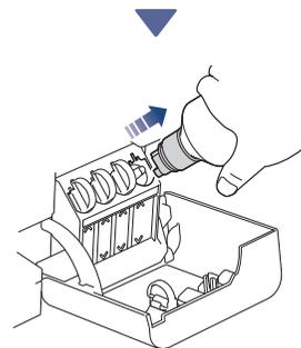
Wenn der Tank voll ist, nehmen Sie die Flasche heraus, indem Sie langsam an der Düse ziehen, damit die Tinte nicht ausläuft.
