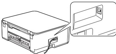
Um eine USB-Verbindung herzustellen, suchen Sie den richtigen Anschluss an der Seite des Geräts (siehe Abbildung).
