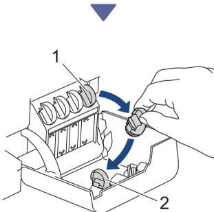
Entfernen Sie die Kappe (1) und legen Sie sie in die Rückseite des Deckels (2).
