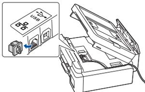
Bestimmen Sie für die verkabelte Netzwerkverbindung und die USB-Verbindung wie dargestellt den korrekten Anschluss (entsprechend dem verwendeten Kabel) im Gerät.
