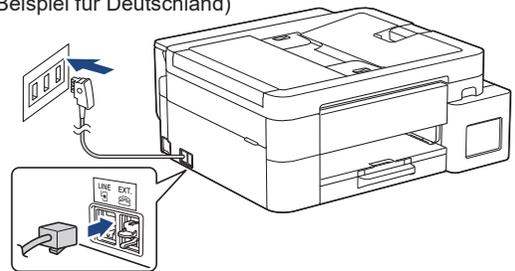
Stecken Sie das Telefonkabel in die Buchse mit der Aufschrift **LINE**.
