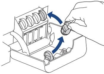
Retirez le bouchon placé à l'intérieur du couvercle du réservoir d'encre et rebouchez le réservoir d'encre.
