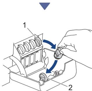
Retirez le bouchon (1) et placez-le à l'intérieur du dos du couvercle (2).
