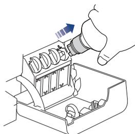
Une fois terminé, retirez la bouteille en extrayant lentement l'embout pour éviter que de l'encre se répande.
