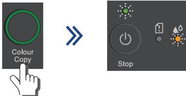
Appuyez sur le bouton **Colour Copy (Copie couleur)** et maintenez-le enfoncé pendant trois secondes pour démarrer le nettoyage initial du système d'encre. Pendant le nettoyage initial, les LED d'alimentation et d'encre clignotent toutes les deux.
