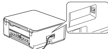
Para realizar una conexión USB, busque el puerto adecuado al costado del equipo, como se muestra en la imagen.
