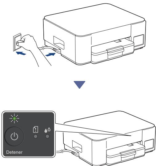
El equipo se enciende de manera automática y el LED de encendido parpadea.
