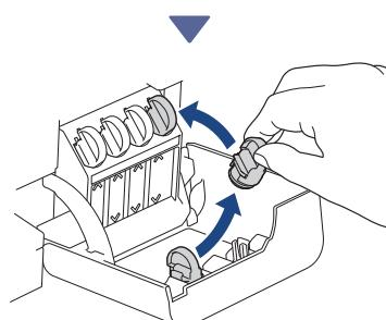
Quite la tapa del interior de la cubierta del tanque de tinta y selle el tanque de tinta.
