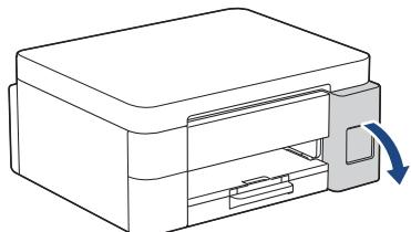
Abra la cubierta de los tanques de tinta.
