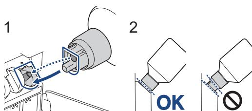
Alinee la botella para que el pasador del tanque de tinta se pueda introducir en el orificio de la botella, como se muestra en (1).
