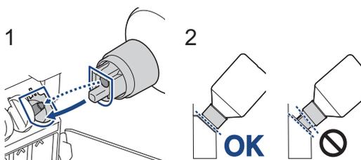
如 (1) 所示，对准墨水瓶，确保墨仓上的插片能够插入墨水瓶孔中。
