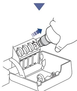
填充完成后，取出墨水瓶，缓慢拉动喷嘴，以防墨水溅出。
