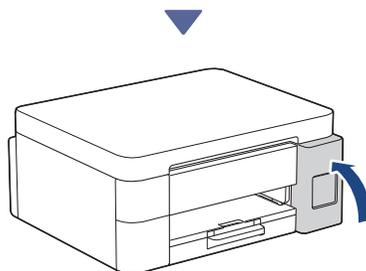
将四个颜色的整瓶墨水全部填充到墨仓后，合上墨仓盖。
