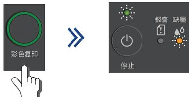
按住**彩色复印**按钮 3 秒钟启动首次墨水系统清洗程序。首次清洗过程中，电源指示灯和墨水指示灯均会闪烁。
