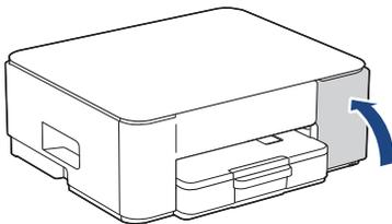
Depois de instalar os quatro cartuchos de tinta, feche a tampa dos mesmos. O equipamento começará a limpeza inicial do sistema de tinta.
