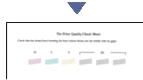
Quando termina a limpeza inicial do sistema de tinta, o equipamento imprime a folha de verificação da qualidade de impressão.
