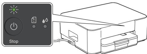
O equipamento liga-se automaticamente e o LED da alimentação fica intermitente.
